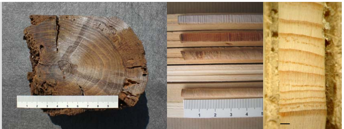
präpariertes Kappstück, Probenmontage und Lupenbild eines auf einem Träger fixierten Bohrkerns (Fichte) (Maßbalken \cong 1 mm), Fotos: KP, W. Hofbauer
